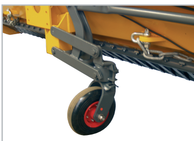
Justerbar støttehjul for afsætning. Nem af- og påsætning på lastbilen.
