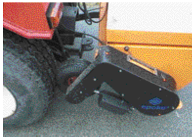
Der PM 1,4 wird von einem Rad angetrieben, das auf traditionelle Kompakttraktoren gegen das Hinterrad gedrückt wird, womit wegabhängige Streuung nach der Geschwindigkeit des Traktors erzielt wird.
