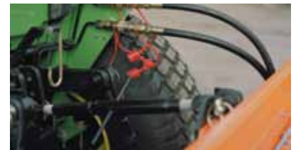
Der PMH 1,4 wird hydraulisch durch eine Danfoss Hydraulikpumpe getrieben und kann für eine Ölmenge von 15 oder 30 l/min bei 160 Bar geliefert werden.
