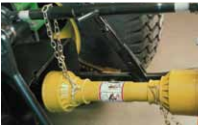
Der PM 1,4 wird von der Zapfwelle des Traktors angetrieben und ist mit 540, 800/1000 bzw. 2000 r/min der Zapfwelle erhältlich.
