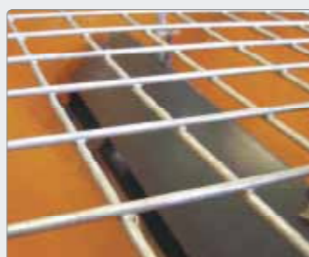
Entlastungsplatte für Minimierung des Materialgewichtes auf dem Förderband (Option)
