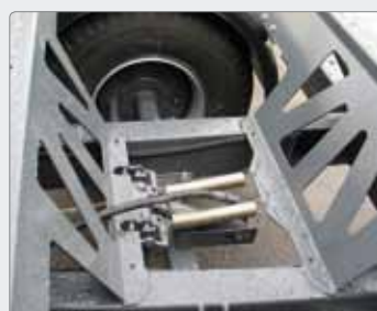
Trailer er udstyret med hydrauliske bremsere.
