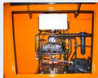
Maskinrum hvor alle styreenheder er gemt af vejen under mottoet "godt beskyttet, men let tilgængelig".
