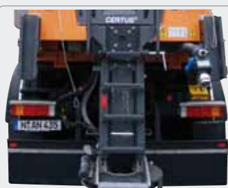
Inspektionsstige er placeret på spredeskivearrangementet for nem og sikker opstigning.
