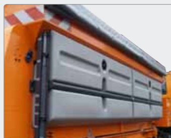
Sidetankene rummer 3500 l og er tilpasset maskinens konturer.
