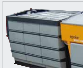
Specielt udviklede væsketanke sikrer en stabil fordeling af væskeindholdet i tankene. De slidstærke væsketanke af termoplastisk materiale er bestandige selv under ekstreme klimaforhold.
