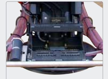
Brede trin på spredeskivearrangementet betyder sikker og ubesværet adgang til maskinrummet.
