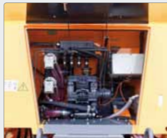
Alle vitale komponenter er samlet i et tæt aflukket maskinrum og således beskyttet mod saltstøv. Desuden er der lagt vægt på øget brugervenlighed for chauffører og servicefolk.
