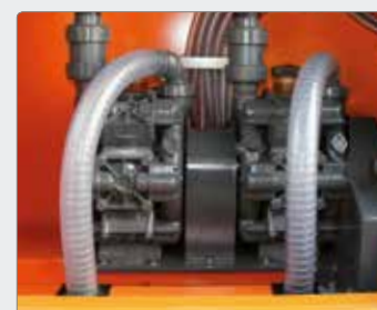
Logisk opbygget væskesystem med membranpumpe.
